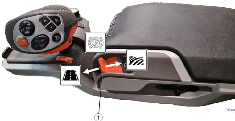
Fig. 120: Mettre le bouton en mode Sur place
