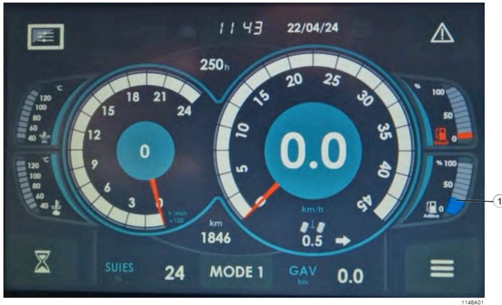
Fig. 169: Affichage du niveau d'AdBlue sur la fenêtre du mode Route
