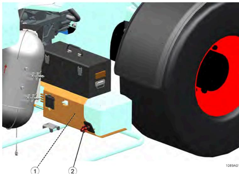
Fig. 58: Batterie et coupe batterie
