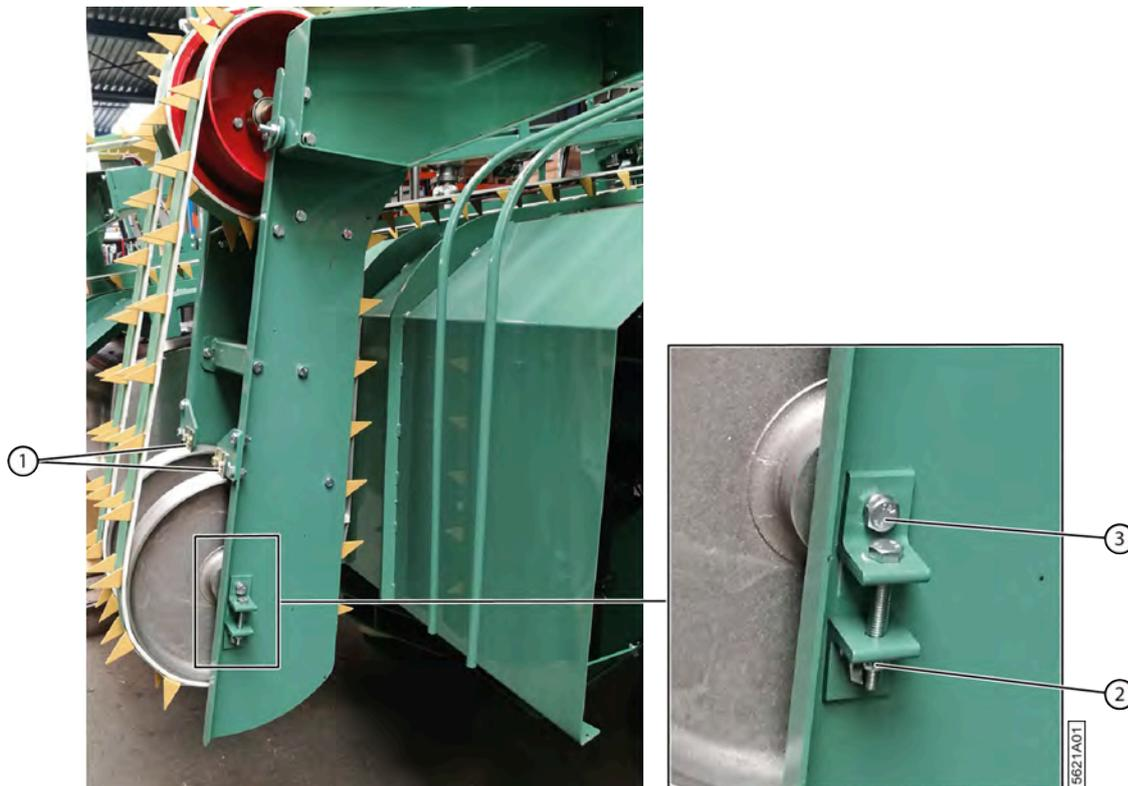
Fig. 152: Régler la tension des courroies déposées
