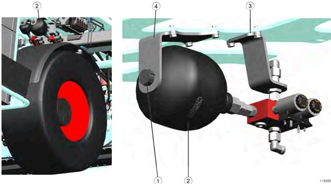
Fig. 183: Localisation du coussin d'azote de l'arracheur
