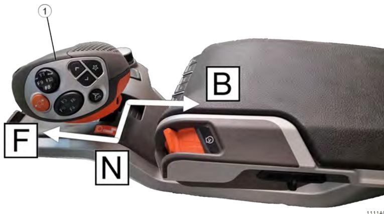
En fonction du mode de conduite sélectionné, la position exacte du joystick a une influence sur la vitesse.
