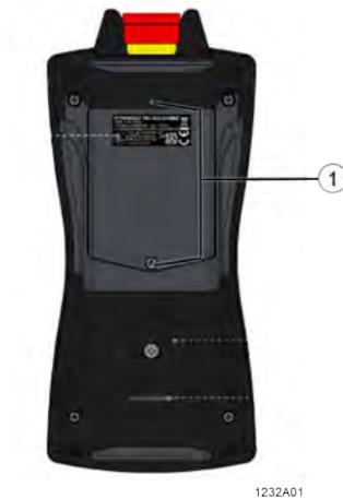
Fig. 111: Remplacer les batteries de la télécommande
