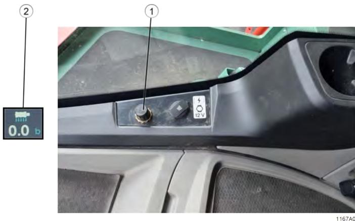
Fig. 150: Régler la pression des rouleaux écraseurs
