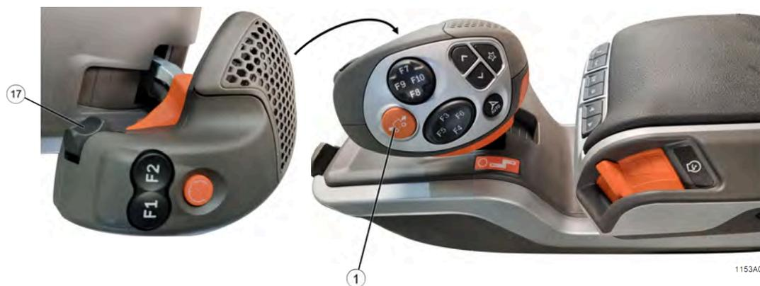
Fig. 124: Réduire ou augmenter la vitesse des courroies d'arracheur
