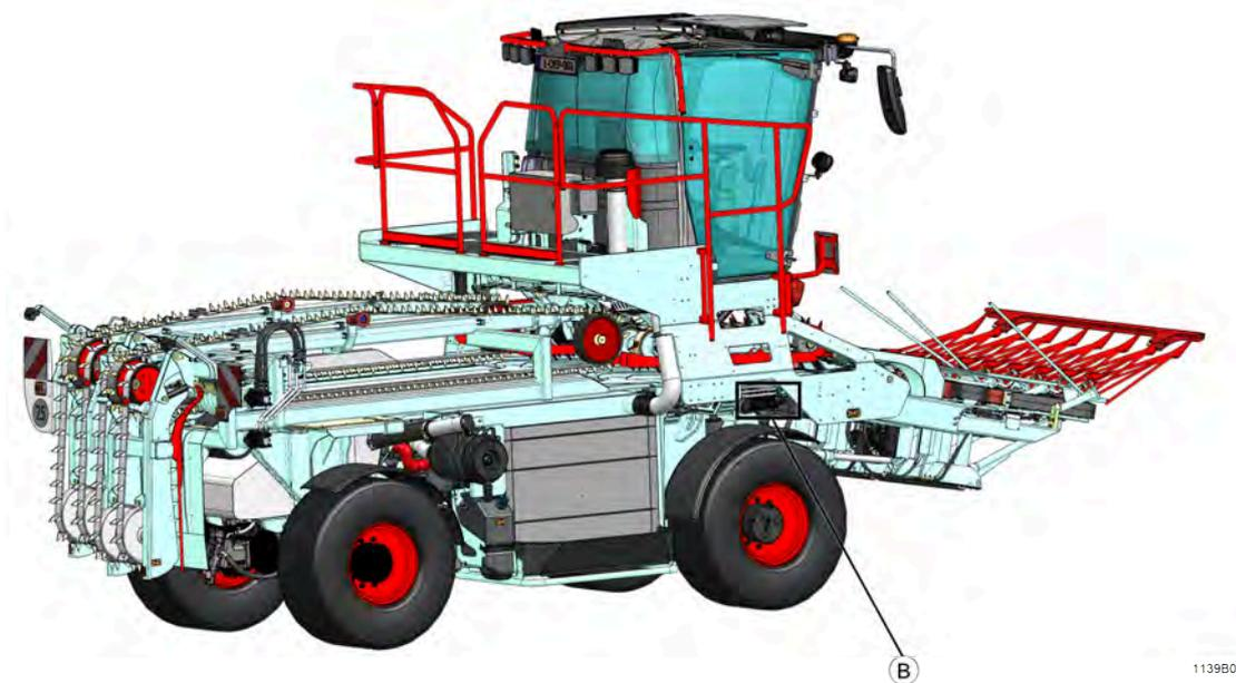
Fig. 83: Localisation des leviers de commande manuelle en bas (B)
