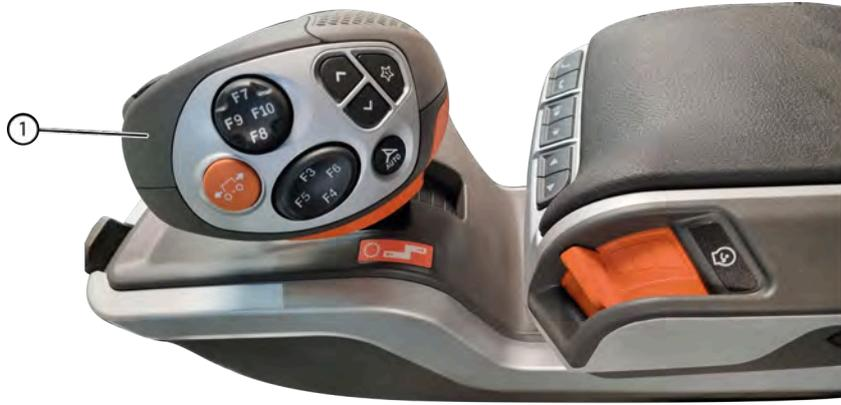
Fig. 98: Joystick multifonctionnel
