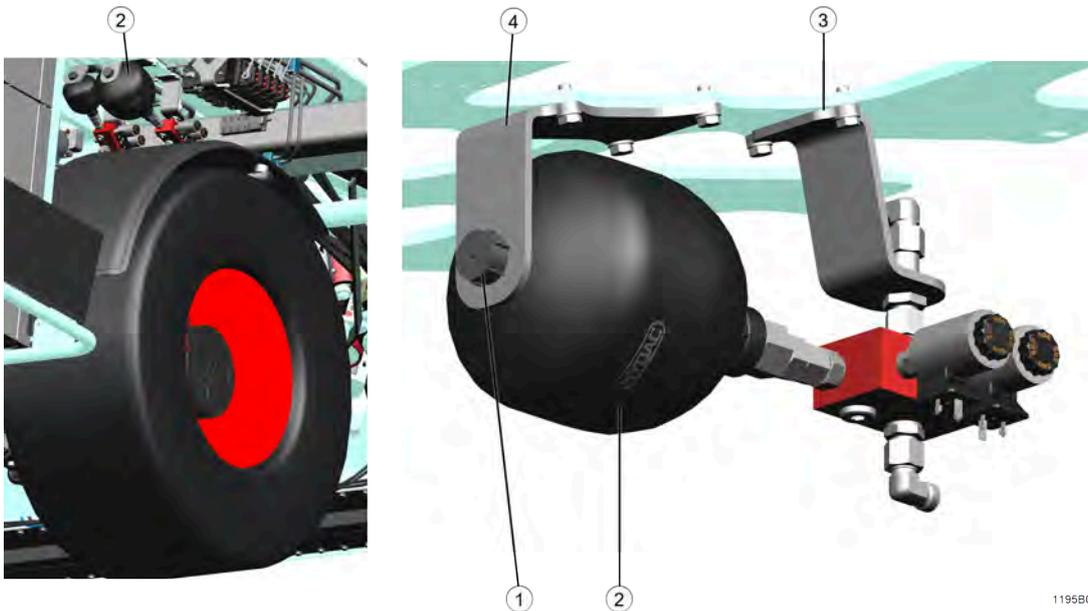
Fig. 182: Localisation du coussin d'azote de l'arracheur
